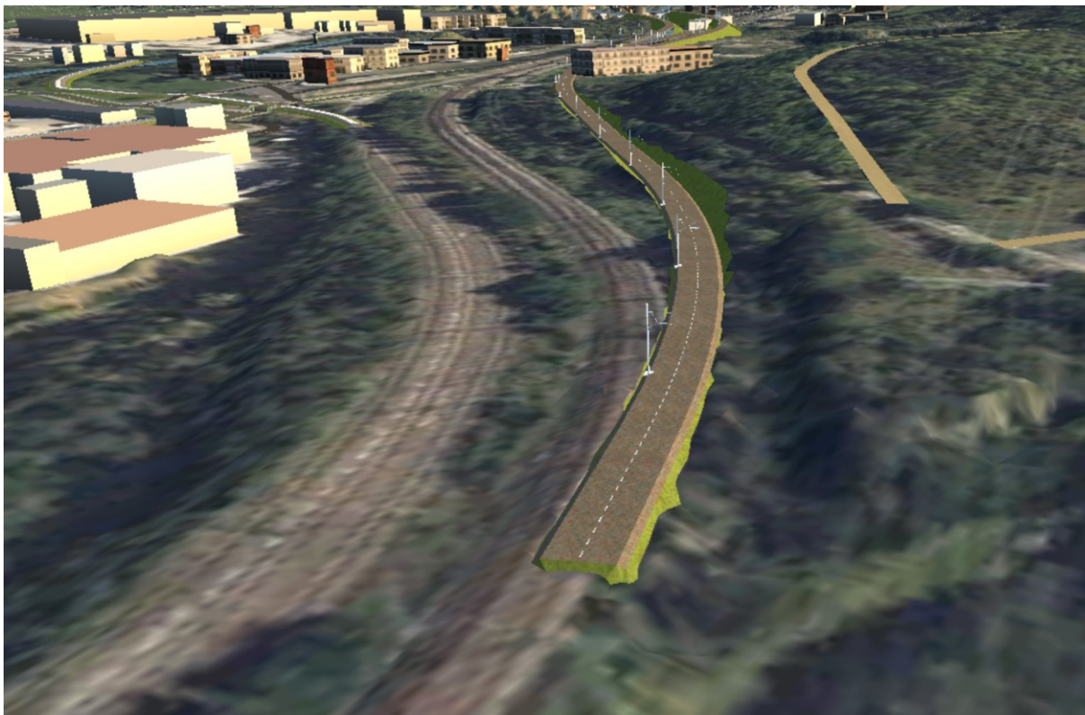
Obrázek 5 – připojení koleje č. 2 do tratě od Bíliny před Trmicemi
